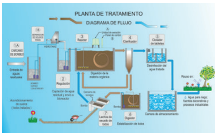
Figura 4. Diagrama esquemático de los procesos en una planta de tratamiento de aguas residuales
